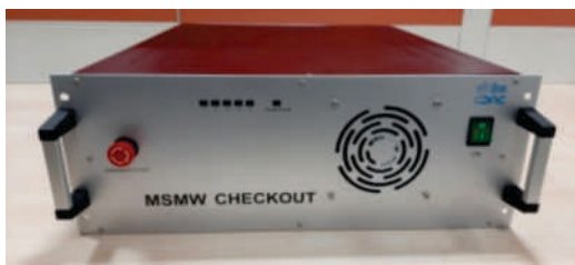
चुंबकीय रूप से निलंबित मोमेंटम व्हील टेस्ट स्टेशन के लिए स्वचालित परीक्षण उपकरण (ATE-MSMW)
