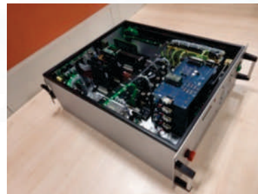
चुंबकीय रूप से निलंबित मोमेंटम व्हील टेस्ट स्टेशन के लिए स्वचालित परीक्षण उपकरण (ATE-MSMW)
