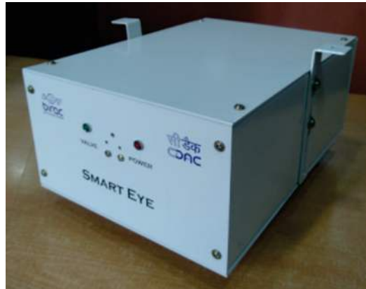
चाय के विदेशी पदार्थ का पता लगाने के लिए स्मार्ट आई सिस्टम
